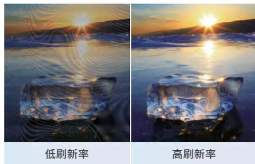
目前 LED 显示屏主要应用为动态扫描的方式，模组从第 1 行的扫描控制、第 2 行的扫描控制……直到最后一行的扫描控制，其过程也基本相同。控制过程都完成后，LED 显示屏就能够出现 1 帧图像的完整显示。虽然按照这种工作方式，LED 显示屏是一行一行点亮的，每次都只有一行亮，但只要保证每行每秒钟能点亮 24 次以上，即刷新频率高于 24 Hz，那么由于人的视觉惰性，所看到的 LED 显示屏显示的图像还是全屏稳定的图像。
